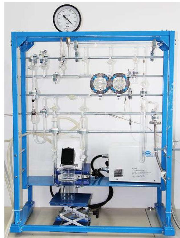
光源（模拟太阳光谱）、光催化反应器（光催化反应进行的场所）、真空反应架（用于光催化反应气体的收集）、气相色谱（用于气体的定性、定量分析）、电脑（用于仪器的设定及实验数据的采集）等。
